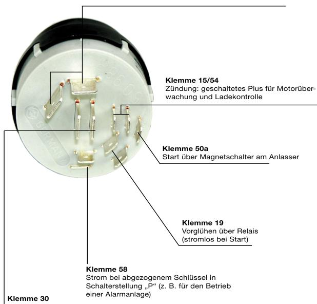
Dauerplus + direkt von der Batterie (beide Anschlüsse belegen bei Vorglühen ohne Vorglührelais)
