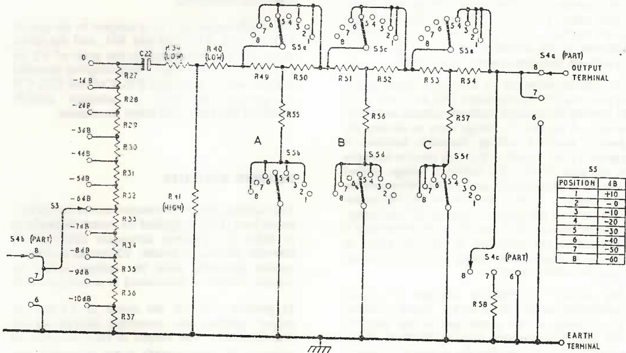
Fig. 6 600Ω Attenuator
