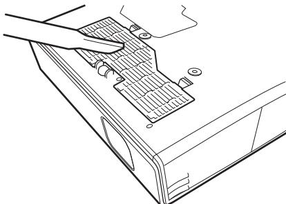
当难以用真空吸尘器清除滤网上的灰尘时，请拆下空气滤网进行清洗。
