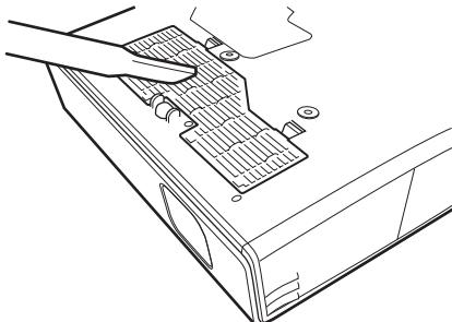
Quando diventa difficile togliere la polvere dal filtro usando l'aspirapolvere, smontare il filtro dell'aria e lavarlo.
