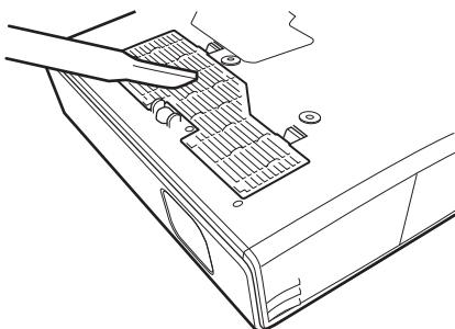
Si resulta difícil retirar el polvo del filtro con un aspirador, desmonte el filtro de aire y lávelo.
