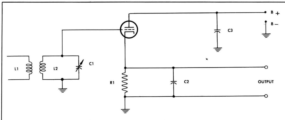
*Infinite Impedance Detector*
