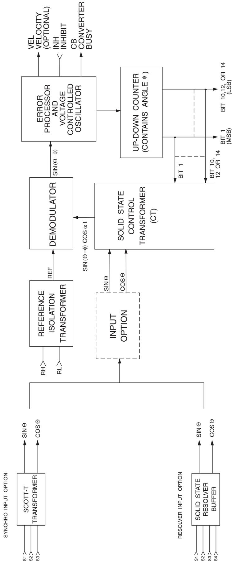
**FIGURE 1. SDC-630/632/634 BLOCK DIAGRAM**
