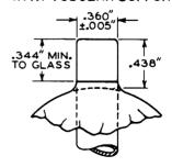
CONNECTOR SHOULD NOT EXERT MORE THAN 7 POUNDS RADIAL COMPRESSION AT ANY POINT AROUND THE CIRCUMFERENCE OF THE CAP.
