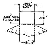
CONNECTOR SHOULD NOT EXERT MORE THAN 10 POUNDS RADIAL COMPRESSION AT ANY POINT AROUND THE CIRCUMFERENCE OF THE CAP.
