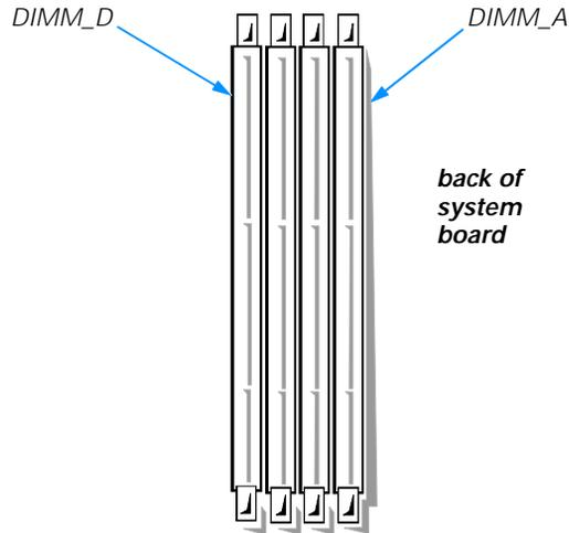
**Figure 8-4. DIMM Sockets**
