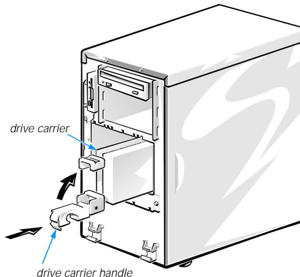
**Figure 10-4. Installing a SCSI Hard-Disk Drive Carrier**
