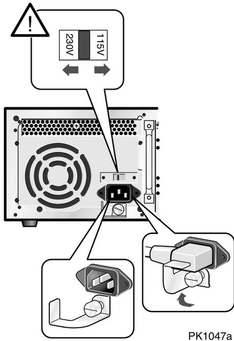
**Figure A-2 Removing Power - DS10L System**
