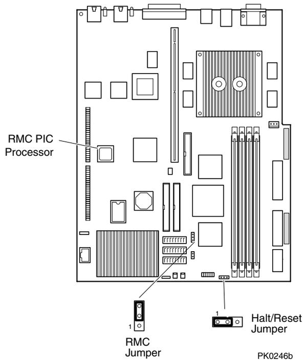
**Figure 3-2 Location of RMC Components on Motherboard - DS10L**
