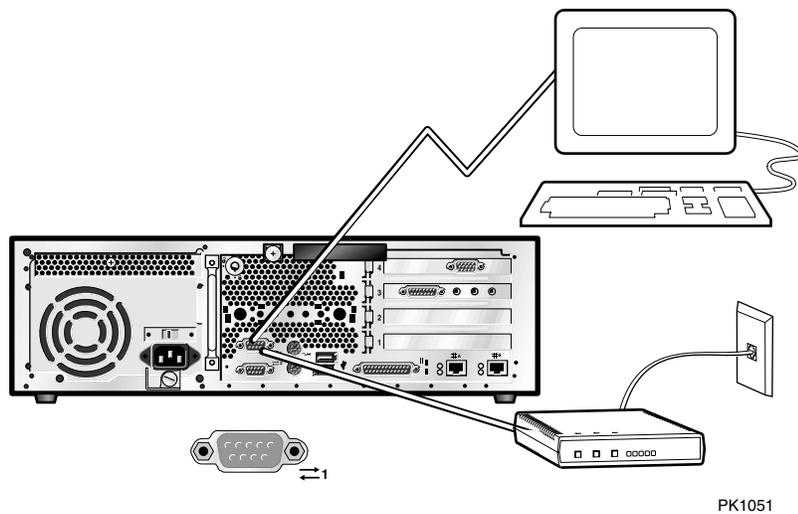
**Figure 3-4 Setups for RMC Mode - DS10L**
