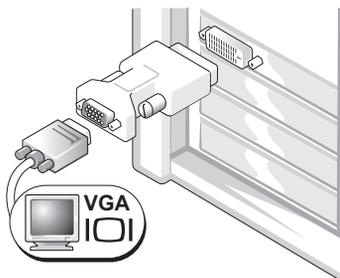
如果您具有单显示器图形卡，并且想将计算机连接至一台 VGA 显示器，请使用 VGA 适配器。
