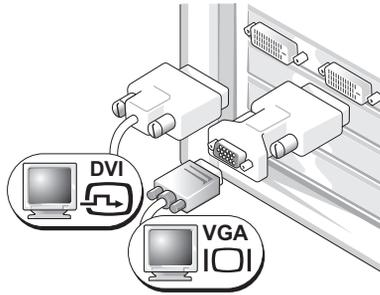
使用 VGA 适配器将 VGA 显示器连接至计算机上的一个 DVI 连接器
