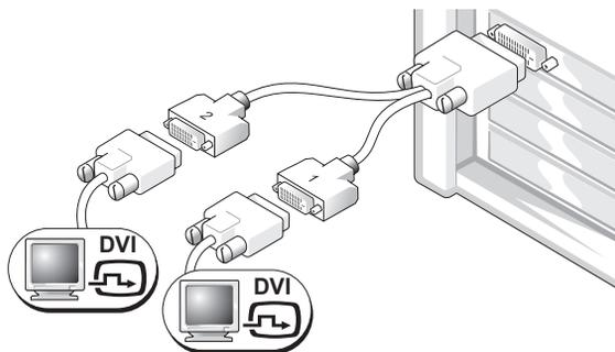
如果您的图形卡只有一个连接器，而您想将计算机连接至一台或两台 DVI 显示器，请使用适当的 Y 型电缆。
