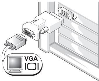
シングルモニターグラフィックカードを装着したコンピュータに 1 台の VGA モニターを接続するには、VGA アダプタを使います。
