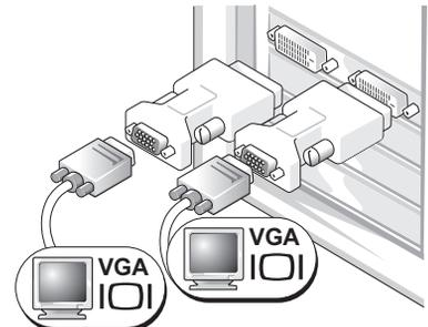
使用两个 VGA 适配器将两台 VGA 显示器连接至计算机上的 DVI 连接器。
