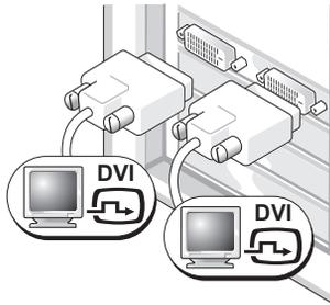
使用 DVI 连接器将计算机连接至一台或两台 DVI 显示器。
