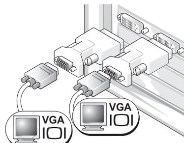
コンピュータの 2 個の DVI コネクタに 2 個の VGA アダプタを取り付けて、2 台の VGA モニターを接続します。
