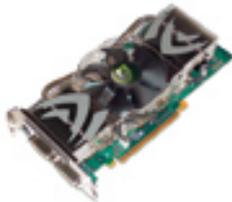
In der Industrie führende Grafiktechnologie mit einer revolutionären neuen Architektur und einer großen Auswahl an erstklassigen Leistungsmerkmalen. Es wird ein ultraschneller 512 MB GDDR3 Speicher für die aktuellen Design- und Visualisierungsanwendungen unterstützt.
