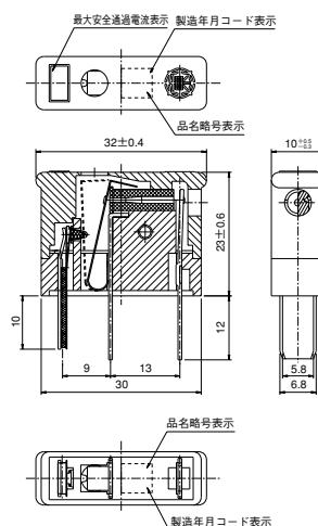
注) 本品は、溶断時に側面の排出口より高温な金属ガスが排出されます。排出口の近傍に可燃物を配置しないなど充分にご留意下さい。
