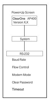
Figure 2.13 . RS-232 parameters LCD submenu
