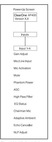
Figure 2.14. Mic Inputs 1-4 parameters
