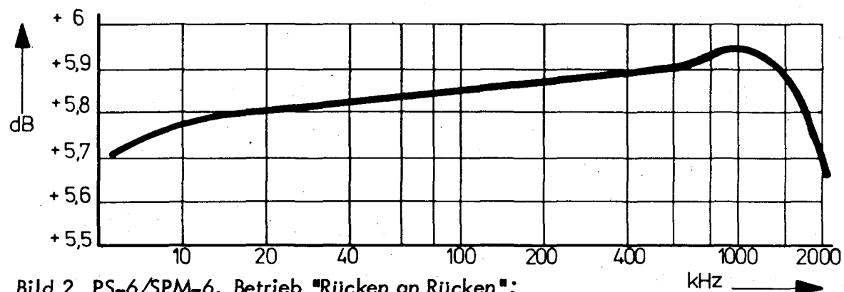
Bild 1 PS-6/SPM-6, Betrieb "Rücken an Rücken"; Ausgangs- und Eingangswiderstand R_i = R_e = 150 \Omega
