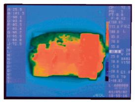
Test condition: M/N : SNP-Z106, Input : 104V Output : 5V/20A, Ambient : 25.5°C
