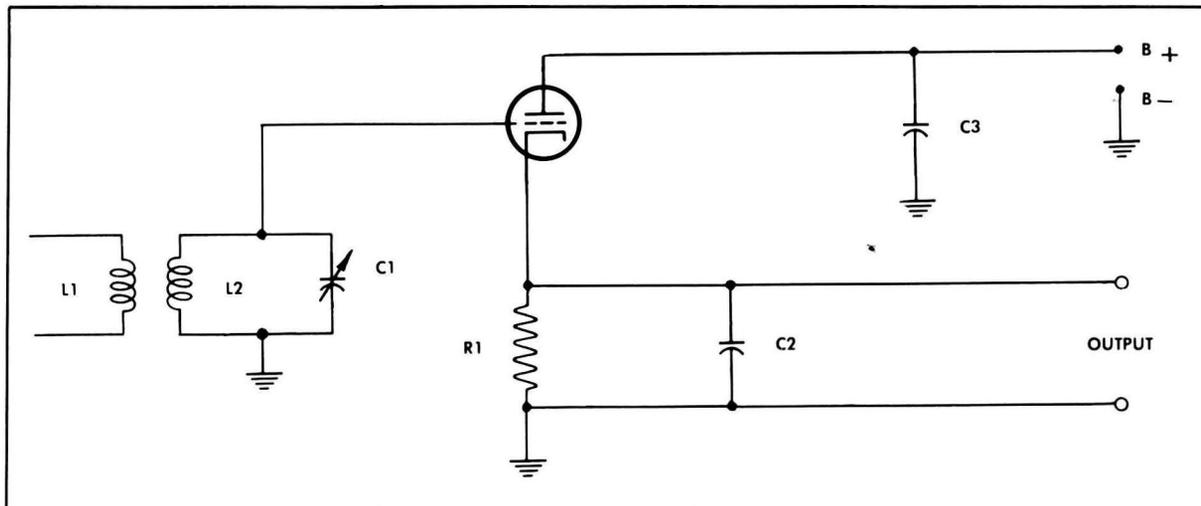
*Infinite Impedance Detector*
