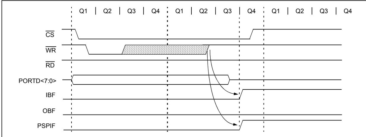
**FIGURE 10-5: PARALLEL SLAVE PORT READ WAVEFORMS**
