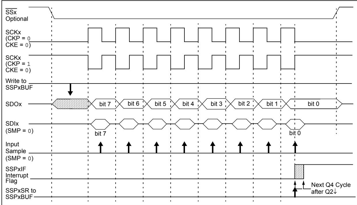
**FIGURE 16-6: SPI MODE WAVEFORM (SLAVE MODE WITH CKE = 1)**
